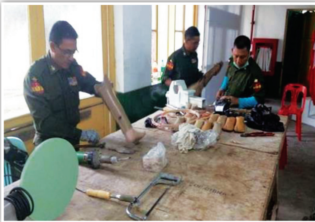
ဆေးနိမ့်စစ်သည်များအား ခြေတုပြုလုပ်ပြင်ဆင်ပေးနေစဉ်။
